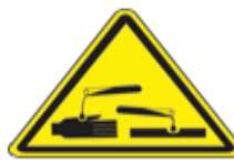
f) Corrosive material hazard
